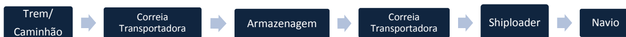
Figura 1 – Fluxograma da operação de desembarque e embarque de granéis vegetais. Fonte: Plano Mestre do Porto de Santos (2019).
